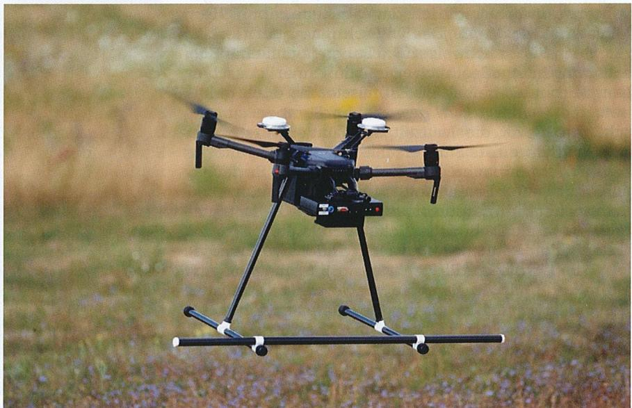
Abbildung 1: DJI Drohne mit Dual-GPS und drei 3-Achs-Magnetometern (im Stab).
