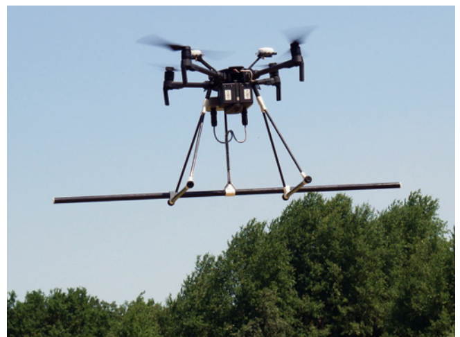
Was wie ein einfacher Besenstiel aussieht, beherbergt das Kernstück der Technik: vier Sensoren, mit denen Magnetfelder in bis zu 4 Meter unterhalb der Erdoberfläche erkannt werden können
