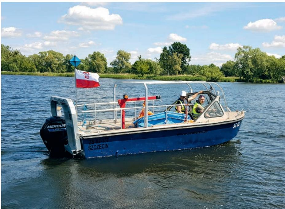
Das Sondier- und Serviceboot ST03 wird auf Binnenwasserstraßen, Seen, in Häfen und im Küstenmeer eingesetzt. Das Aluminiumboot verfügt über eine Tauchplattform zum Einsatz von Tauchern. Optional können z. B. Multibeam, Sidescan Sonar, Subbottom-Profilier und Probenahme-Ausrüstung mobilisiert werden.
