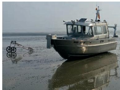
Das Vermessungsboot ST04 kann auf Binnenwasserstraßen, Seen, in Häfen und im Küstenmeer eingesetzt werden. Das Aluminiumboot kann mit einem Tiefwasserrahmen (bis 12 m Wassertiefe) zur Kampfmittelsondierung (Magnetik/Elektromagnetik) mobilisiert werden. Multibeam, SideScan Sonar und Subbottom-Profilier sind optional einsetzbar.
