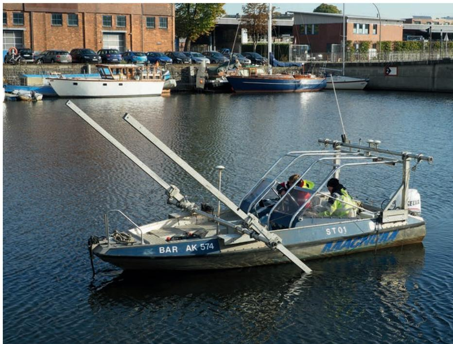
Das Vermessungsboot ST01 kann auf Binnenwasserstraßen, Seen, in Häfen und im Küstenmeer eingesetzt werden. Das Aluminiumboot kann mit einem Tiefwasserrahmen (bis 12 m Wassertiefe) zur Kampfmittelsondierung (Magnetik/Elektromagnetik) mobilisiert werden. Multibeam, SideScan Sonar und Subbottom-Profilier sind optional einsetzbar.
