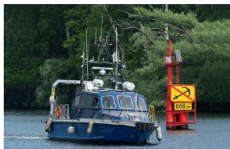
Das ehemalige Seenotrettungsschiff TRIO wird vornehmlich als Vermessungsschiff im Küstenmeer, auf Binnenwasserstraßen, Seen und in Häfen eingesetzt. Die Motoryacht ist aber auch flexibel als Serviceschiff und Guardvessel einsetzbar. Die TRIO kann mit ROV-System oder geschlepptem Equipment (Scanfish) zur Unterwasserinspektion und/oder zur Kampfmittelsondierung (Magnetik/Elektromagnetik) mobilisiert werden. Multibeam, SideScan Sonar und Subbottom-Profilier sind optional einsetzbar.
