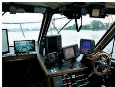
Das Vermessungsboot SOLO wird auf Binnenwasserstraßen, Seen, in Häfen und im Küstenmeer eingesetzt. Die Motoryacht kann auch flexibel als Serviceschiff eingesetzt werden. Die SOLO kann mit einem Tiefwasserrahmen (bis 18 m Wassertiefe) zur Kampfmittelsondierung (Magnetik/Elektromagnetik) mobilisiert werden. Alternativ steht ein ROV-System zur Unterwasserinspektion zur Verfügung. Multibeam, SideScan Sonar und Subbottom-Profilier sind optional einsetzbar.
